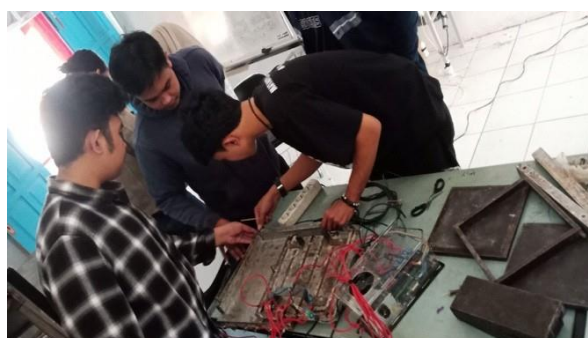
Gambar 2. Persiapan alat mesin hot-press dengan controller arduino
