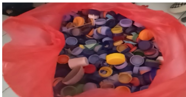
Gambar 1. Persiapan bahan plastik jenis HDPE dari tutup botol plastik
