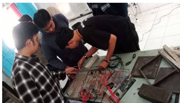
Gambar 2. Persiapan alat mesin hot-press dengan controller arduino
