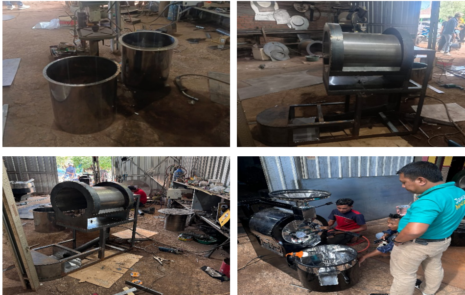
Gambar 2. Mesin penggoreng Kopi semi otomatis
