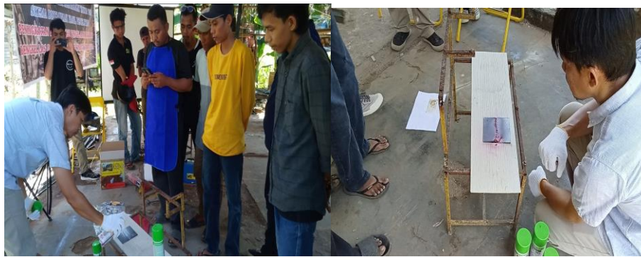
Gambar 5. Praktek pengujian NDT dengan penetrant test
