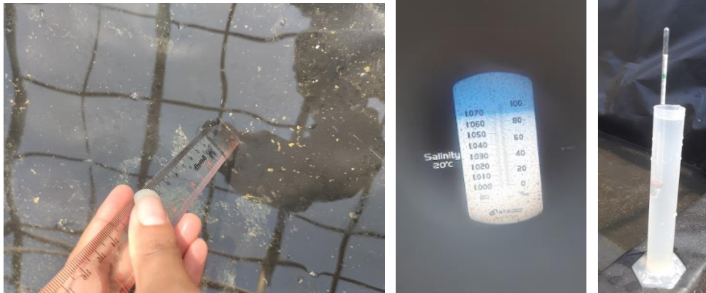
Gambar 3. Pengukuran salinitas dan °Be air laut di dalam tunnel
